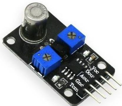
Рис. 1.5 Модуль з датчиком вуглекислого газу TGS4161
